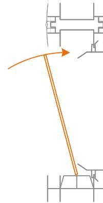
**C)** mettre la vitre en place, utiliser les gants anti coupure
